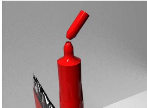
**3 - PUSH TUBING ONTO CONNECTOR**
